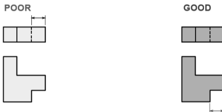
รูปที่ 3.28 การหลีกเลี่ยงการบอกขนาดกับเส้นประ (จิรพงศ์ กสิวิทย์อำนวย, 2550)
