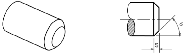
รูปที่ 3.23 ทรงกระบอกที่มี Chamfer (จิรพงศ์ กสิวิทย์อำนาจ, 2550)
